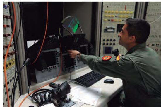
El Grupo de Software vuelca sus desarrollos en los bancos de validación, como el del *Eurofighter* (en la imagen superior). En el Grupo de Armamento se inspeccionan misiles, como el *IRIS-T* (izquierda) y se analizan muestras de pólvora (debajo).
