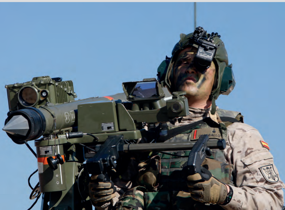
La actualización tecnológica del sistema de misiles Mistral 3 conlleva una cámara infrarroja, hardware de nueva generación y avanzados simuladores de tiro.
