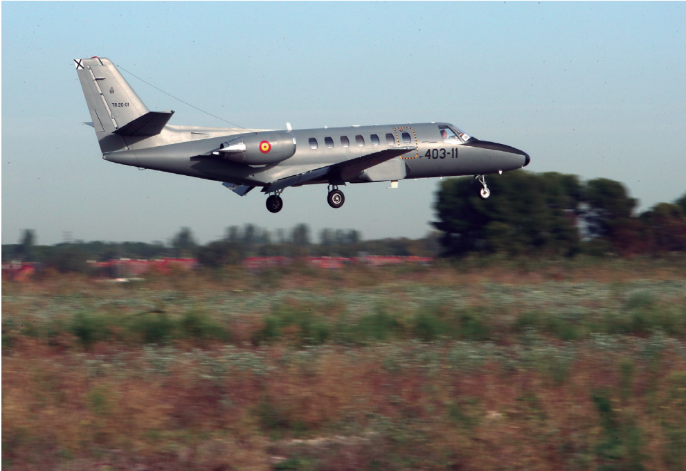
Un avión Cessna Citation V TR (Transporte y Reconocimiento) del 403 Escuadrón de Fuerzas Aéreas configurado para tomar fotografías aéreas toma en la base aérea de Getafe tras un vuelo fotogramétrico en la península.
