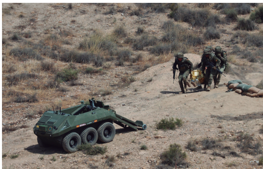
Un grupo de legionarios acerca una baja hasta el vehículo Alano , en configuración MEDEVAC, para su evacuación hasta el primer puesto de clasificación de heridos.
