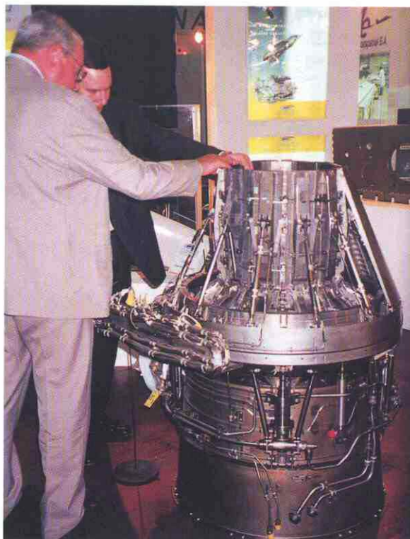
Motores. La tobera vectorial desarrollada por ITP para el EF-2000 (Eurofighter) fue otra de las novedades.
